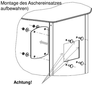
Lackschicht vorsichtig mit einem Messer durchtrennen, danach die Abdeckplatte entfernen!
