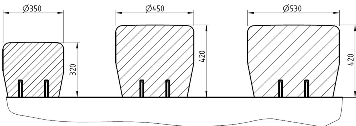
Betonhocker  $\varnothing$  350 muss zusätzlich mit Injektionsmörtel Fixiert werden!
