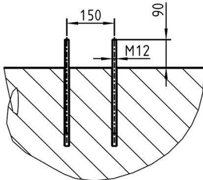
2x M12 A2/A4 Gewindestangen mit Injektionsmörtel (z.B. HIT-HY 200 A) mit einem Abstand von 150 mm setzen. Maximaler Überstand 90 mm.
