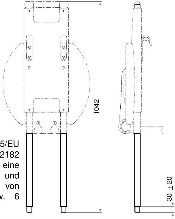
CE-Konform nach 2017/745/EU und geprüft nach DIN EN 12182 sowie ISO 17966 für eine Gebrauchslast von 150 kg und über eine Lebensdauer von 22.000 Lastwechseln bzw. 6 Jahren.
